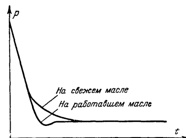
Рис. 4-9. Время достижения остаточного давления на свежем и работавшем (обезгажившемся) маслах.
